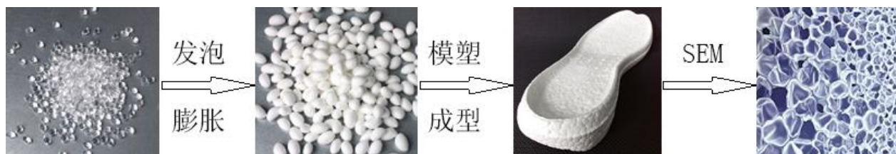
图 2 鞋底成型工艺过程
